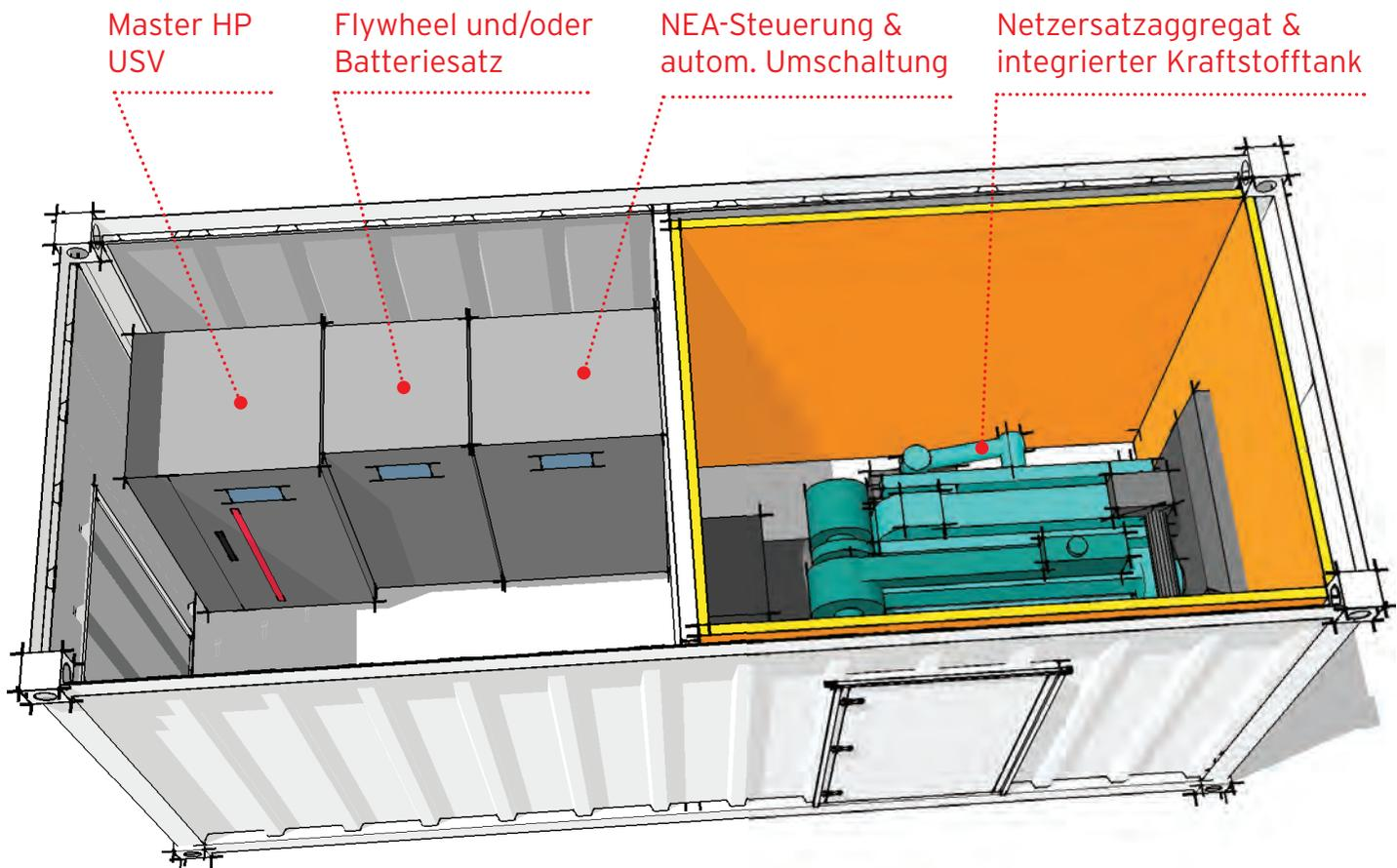
Die **Master HP USV** ist eines der wirtschaftlichsten und raumsparenden unterbrechungsfreien Stromversorgungssysteme, das derzeit verfügbar ist. Ein hoch entwickelter IGBT-basierter Gleichrichter gewährleistet ein System, das keinerlei Auswirkungen auf die Stromversorgungsquelle hat (Zero Impact Source) und die folgenden Eigenschaften aufweist:
